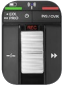
Schiebeschalter: Aufnahme, Stop, Wiedergabe, Rücklauf (LFH3010)
